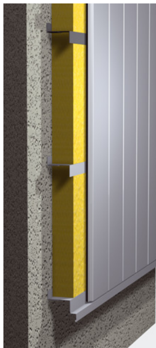
Vertikalverlegung auf Beton
