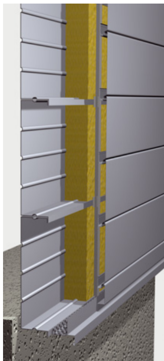
Pose horizontale sur caisson d'acier
